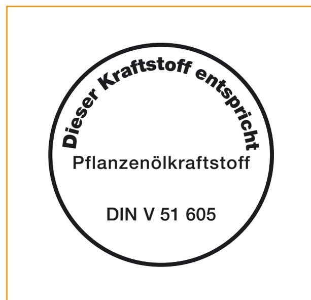
Abb. 73: Zeichen für Pflanzenölkraftstoff an Zapfsäulen und Tankstellen, gemäß 10. BImSchV, Anlage 7<sup>[15]</sup>
