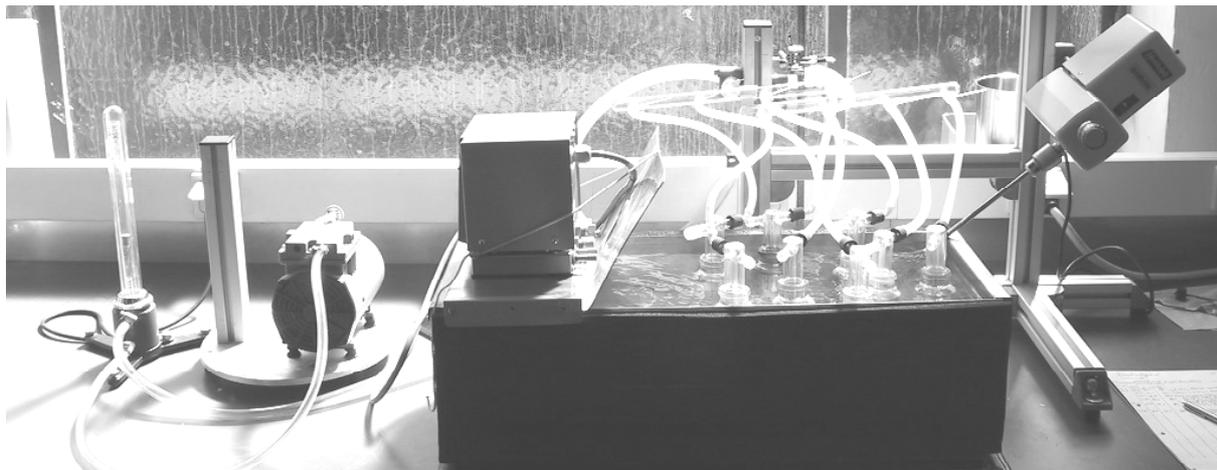
Abbildung 14: Versuchsaufbau Vorversuche Ölalterung
