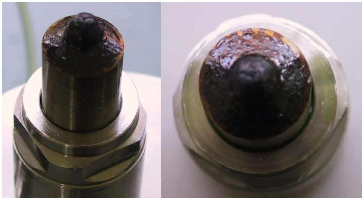
Abbildung 25: Ablagerungen an der Einspritzdüse des FIT-1 nach mehreren Cetanzahlmessun- gen von Rapsölmotorkraftstoff
