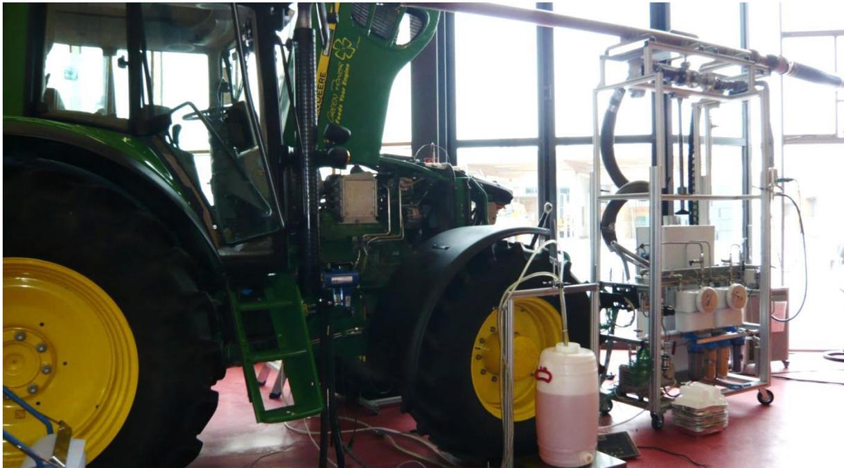
Abbildung 2: Traktorenprüfstand am Technologie- und Förderzentrum
