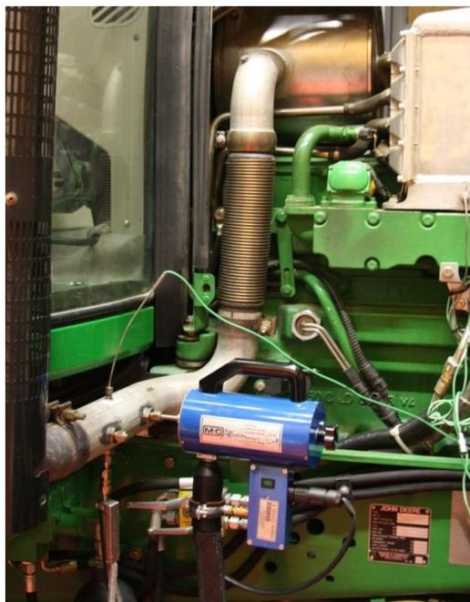
**Abbildung 5:** Gasprobenahme am Abgasrohr
