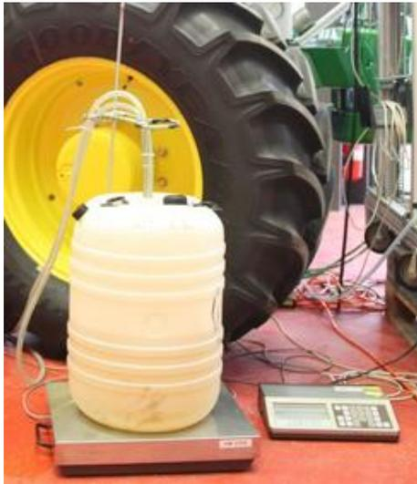
Abbildung 4: Aufbau zur Bestimmung des Kraftstoffverbrauchs mittels Wägung
