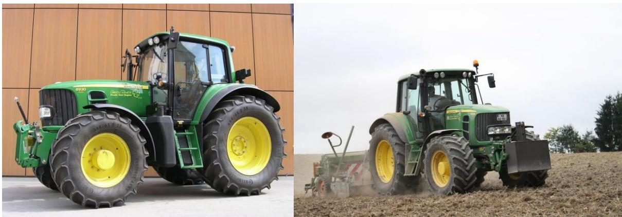
Abbildung 1: John Deere 6930 Premium (pflanzenöлтаuglicher Prototyp)
