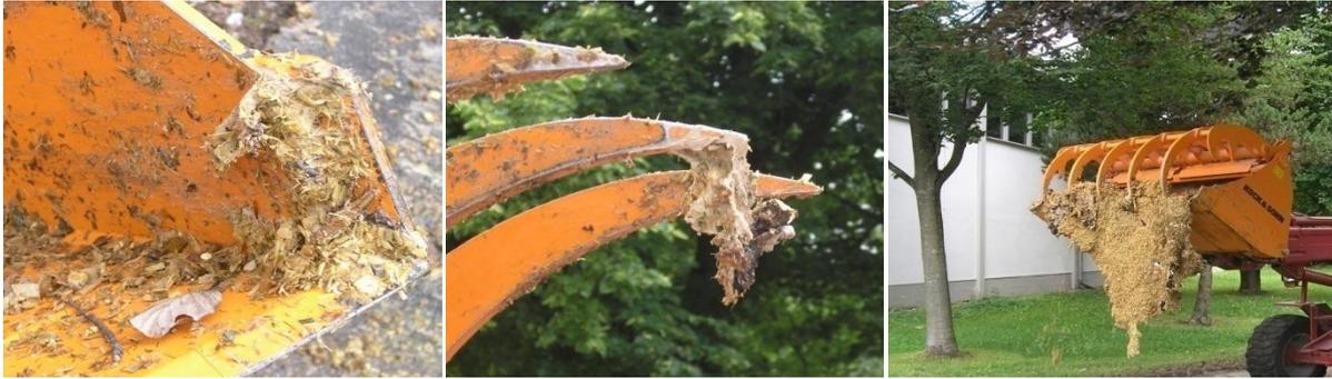
Abbildung 34: Anhaftungen des Abdeckmaterials an der Greifschaufel, abgeschobenes Teilstück
