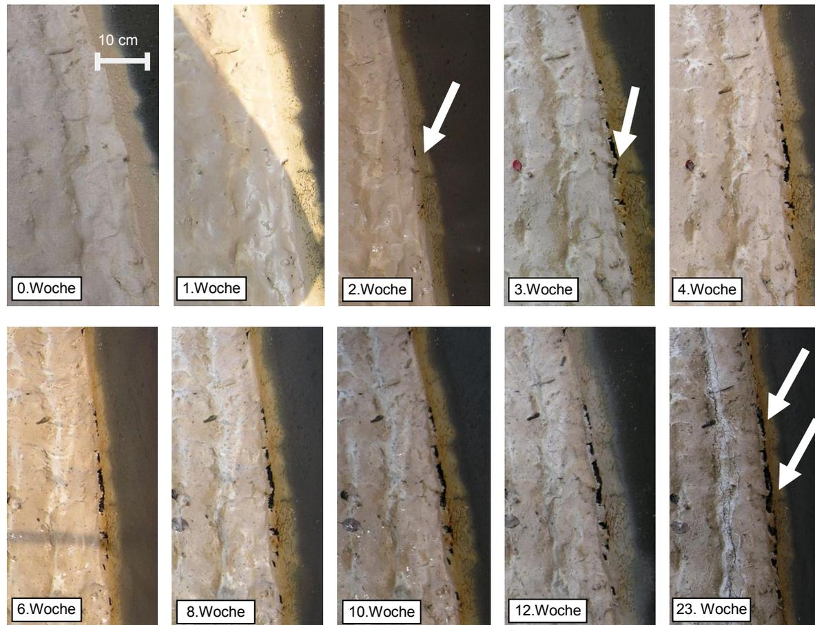
Abbildung 50: Beispiel für die Spaltenbildung am Wandanschluss in zeitlicher Abfolge im Versuchszeitraum 2009/10 (VJ-1)
