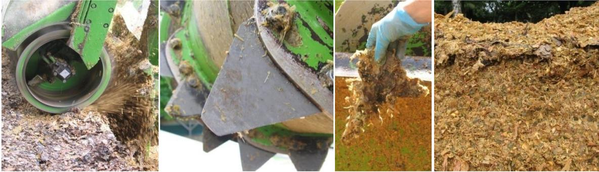
*Abbildung 31: Fräsbild, Messerzustand, abgefräste Abdeckung vor Mischung und Anschnittfläche Silostock nach Fräsvorgang im Juni 2010*
