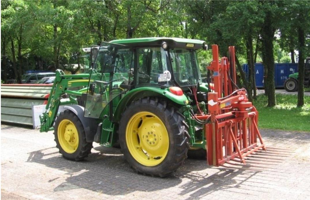
Abbildung 15: Siloblocksneider im Heckanbau
