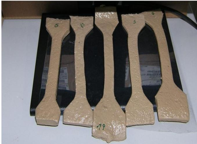
Abbildung 38: Proben nach 24 h Bestrahlung mit UV-Licht
