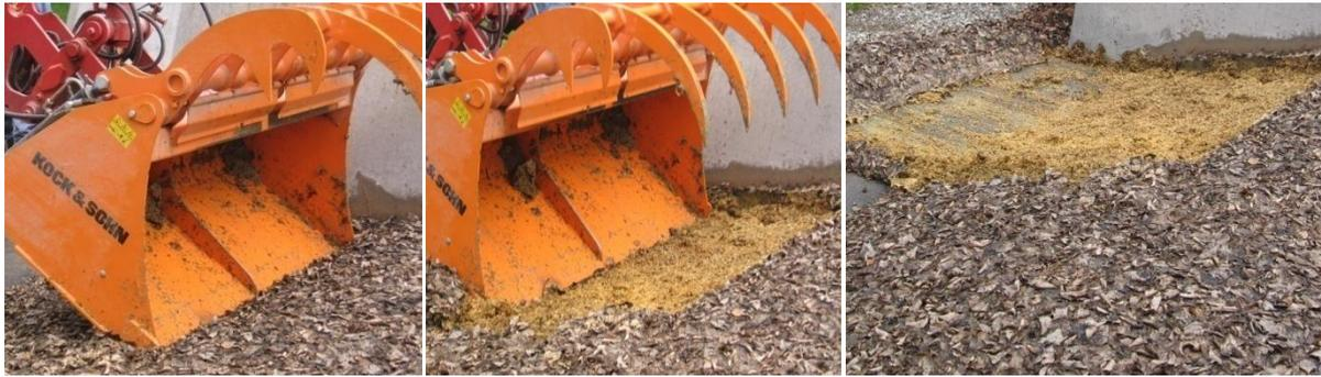
Abbildung 32: Greifschaufel „auf Zug“
