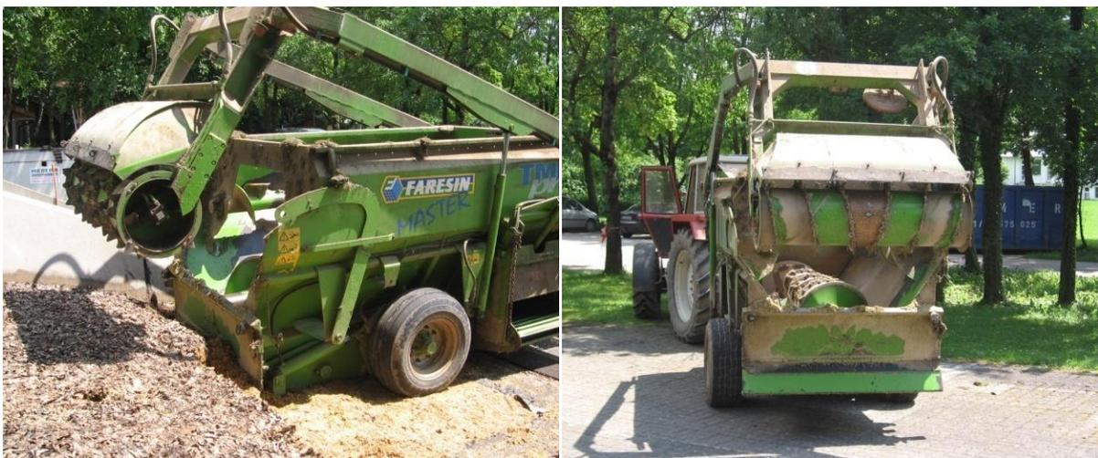
Abbildung 16: Fräsmischwagen
