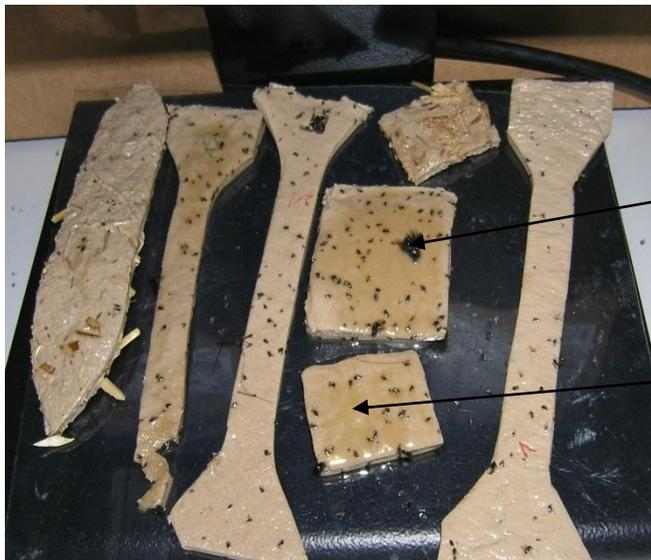
Abbildung 39: Proben unter UV-Licht nach 5 Wochen Bestrahlung
