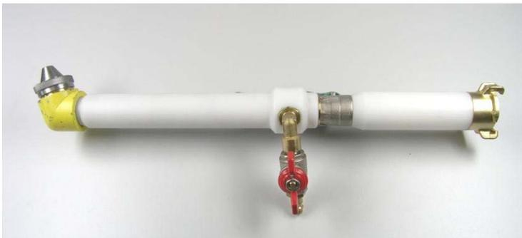
Abbildung 10: Feinputzspritzgerät
