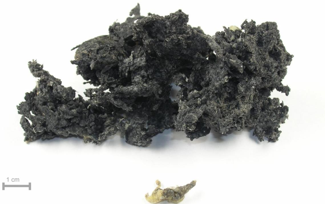
Abbildung 26: Latex-Koagulat entnommen aus der Membranpumpe (vorne) und aus der Exzentrerschneckenpumpe (hinten)
