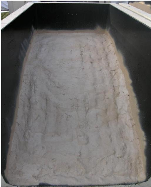
Abbildung 46: Frisch mit dem Abdeckmaterial verschlossenes Versuchssilo (Variante mit Rückwand, VJ-1)
