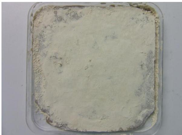
*Abbildung 43: Mit Futterkalk abgestreute Probe der Vorzugsrezeptur*
