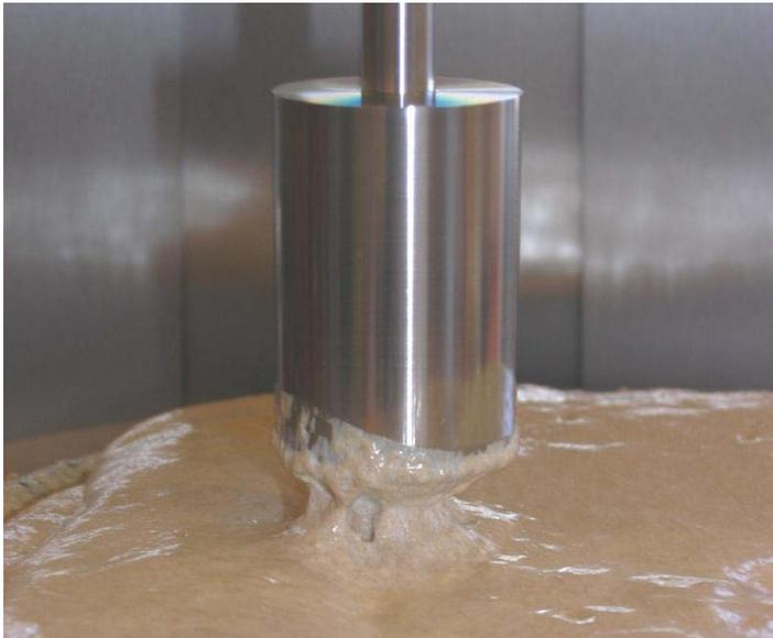
*Abbildung 18: Penetrometermessung – Beispiel: Herausbewegen des Prüfkörper aus der Probe*
