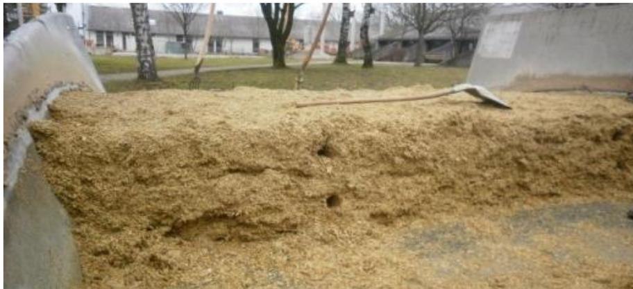
Abbildung 55: Linksseitige horizontale Probenahmestellen am Versuchssilo in der Versuchssiloanlage II
