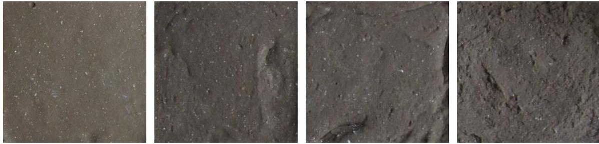
Abbildung 42: Versuch zum Einmischen von Fasern – ganz rechts: Basismischung, links: drei Varianten mit ARBOCEL-Fasern (JRS)
