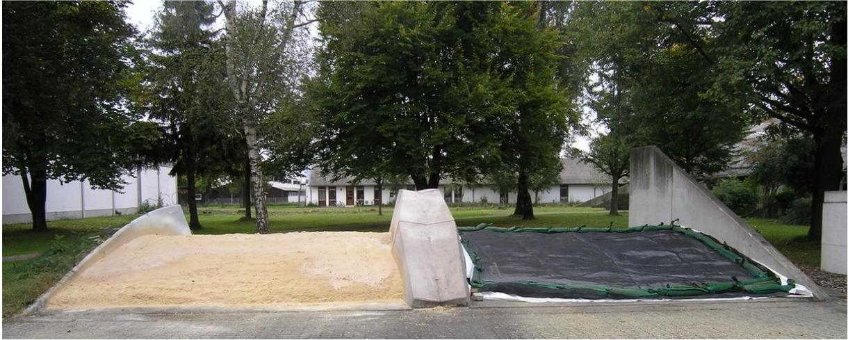
*Abbildung 13: Versuchssiloanlage II im zweiten Versuchsjahr (VJ-2): links neuartige Abdeckvariante, rechts konventionelle Folienabdeckung*
