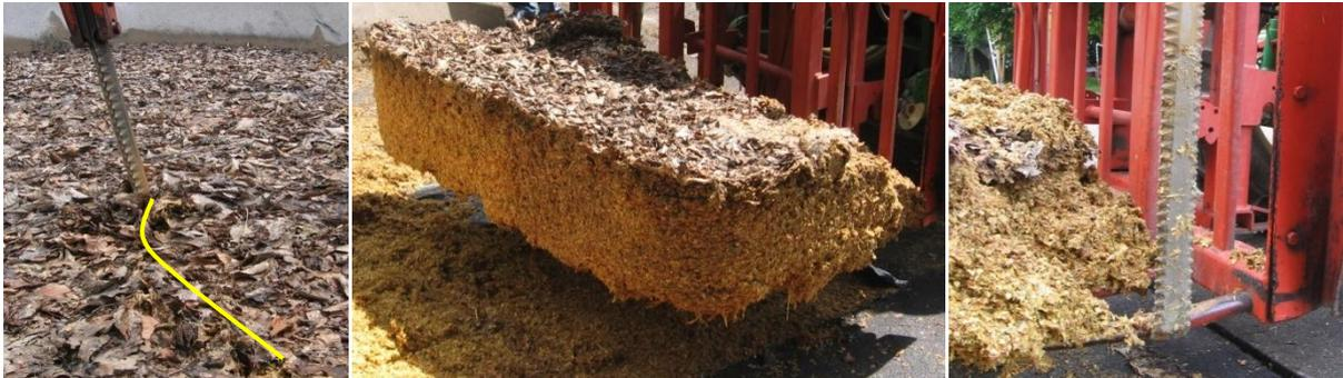
*Abbildung 30: Nachgezeichneter Schnittverlauf, herausgetrennter Siloblock samt Abdeckmaterial und Messerzustand nach Abschluss des Vorgangs*
