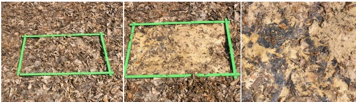
*Abbildung 51: Von Laub befreiter Ausschnitt des Abdeckmaterials und erkennbare Verrottung auf der Oberfläche der Versuchssiloanlage II im VJ-2*
