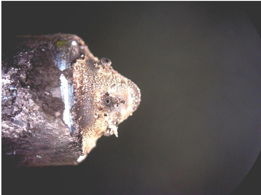
*Abbildung 8: Spitze der Einspritzdüse Nr. 2 aus dem Vorversuch nach einer Laufzeit von 144 h*
