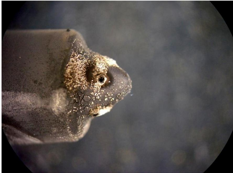
Abbildung 9: Spitze der Einspritzdüse Nr. 1 aus dem Vorversuch nach einer Laufzeit von 25 h
