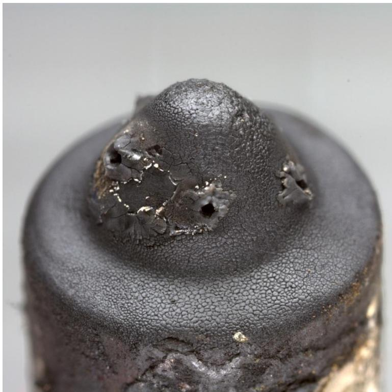
*Abbildung 56: Einspritzdüse des Testlaufs mit Additiv-Rapsölkraftstoff-Mischung A07*
