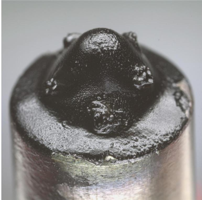
Abbildung 46: Einspritzdüse aus dem Testlauf Nullprobe 1 (von der Vorderseite)
