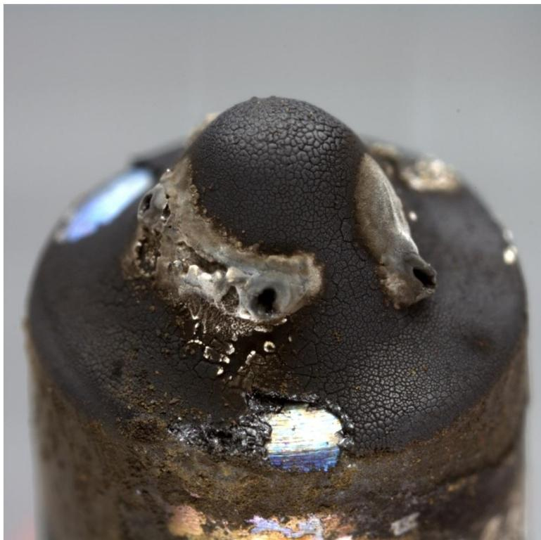
Abbildung 48: Einspritzdüse nach dem Testlauf Nullprobe 2
