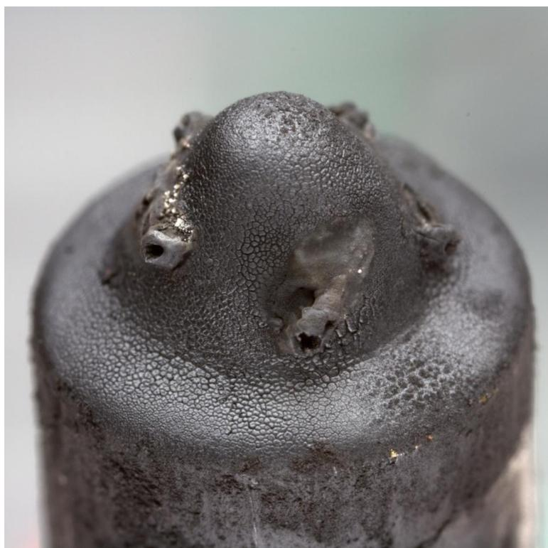
*Abbildung 57: Einspritzdüse des Testlaufs mit Additiv-Rapsölkraftstoff-Mischung A08*
