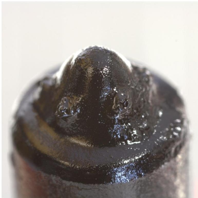
*Abbildung 51: Einspritzdüse des Testlaufs mit Additiv-Rapsölkraftstoff-Mischung A03*
