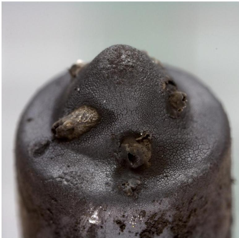
*Abbildung 52: Einspritzdüse des Testlaufs mit Additiv-Rapsölkraftstoff-Mischung A04*
