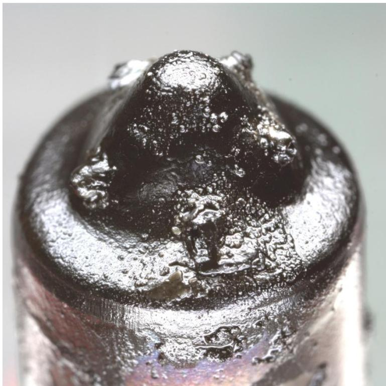
*Abbildung 54: Einspritzdüse des Testlaufs mit Additiv-Rapsölkraftstoff-Mischung A05*
