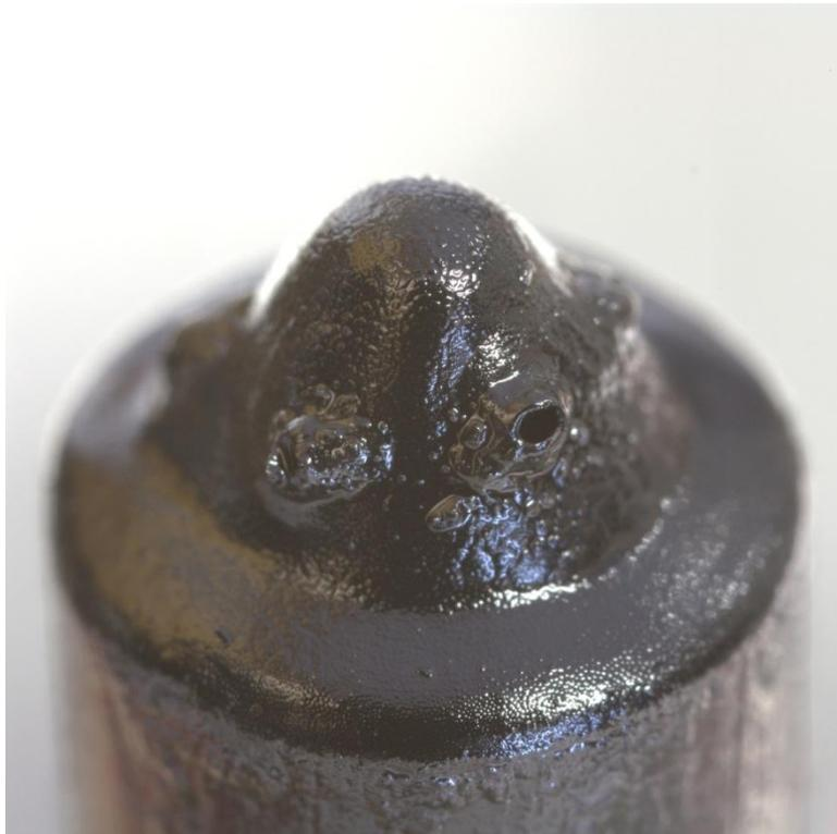
*Abbildung 50: Einspritzdüse des Testlaufs mit Additiv-Rapsölkraftstoff-Mischung A02*
