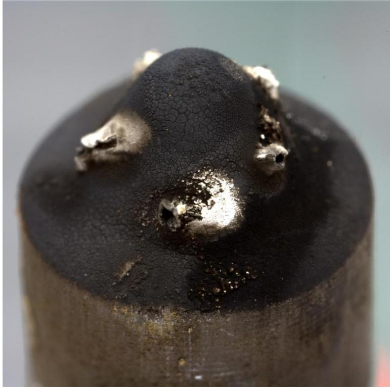
*Abbildung 49: Einspritzdüse des Testlaufs mit Additiv-Rapsölkraftstoff-Mischung A01*
