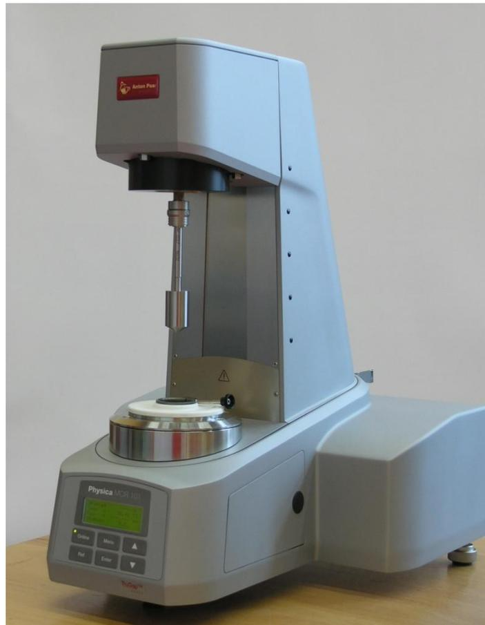
Abbildung 2: Rotationsviskosimeter Anton Paar MCR 101
