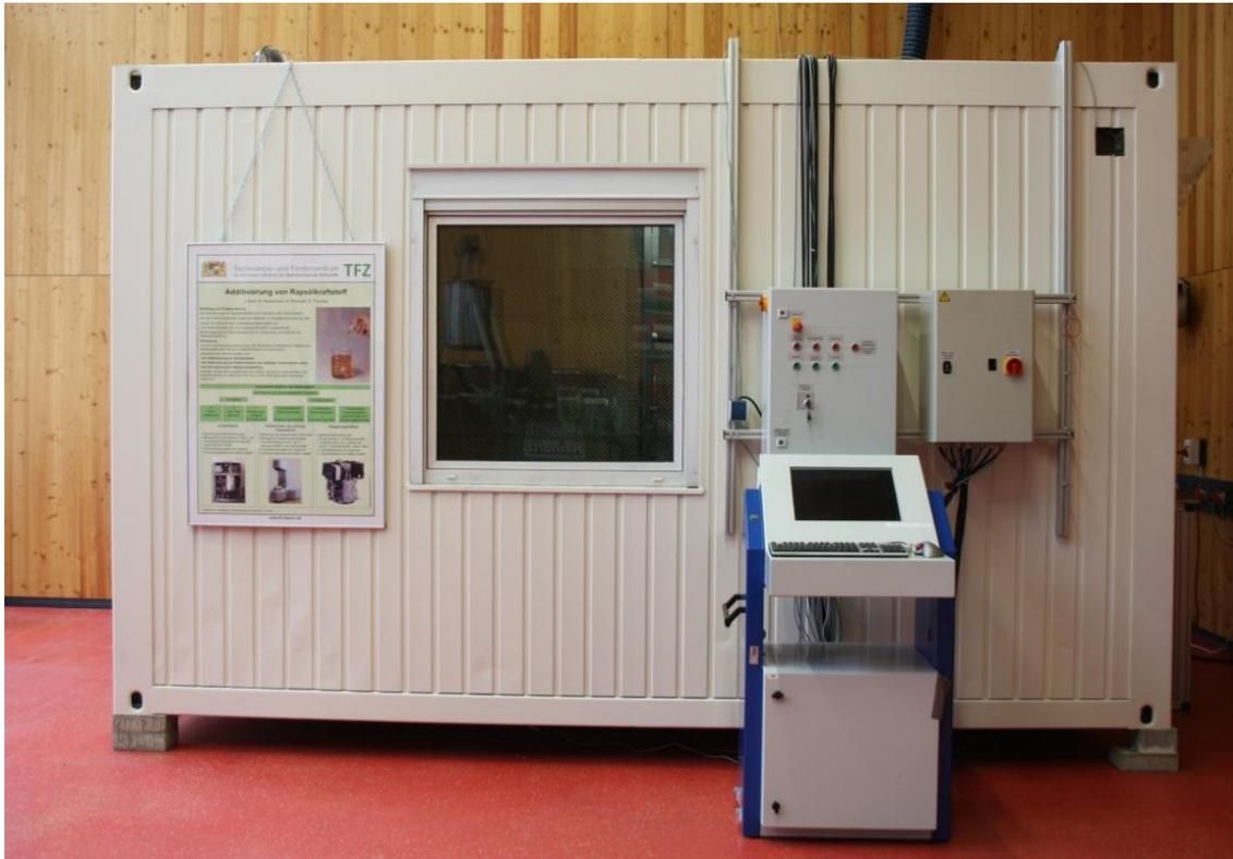
*Abbildung 12: Seitenansicht des Prüfstandscontainers mit Bedienkonsole und Datenerfassungsrechner*
