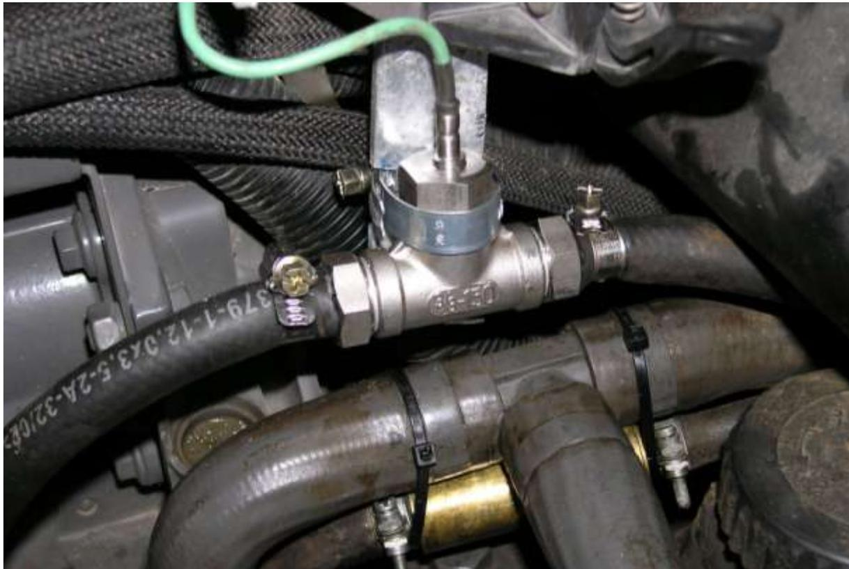
Abbildung 7: Messstelle zur Erfassung der Kraftstofftemperatur beim Fendt Farmer Vario 412
