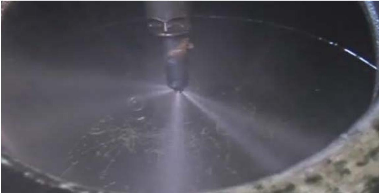
*Abbildung 36: Sprühbild der Einspritzdüse des fünften Zylinders des Deutz-Fahr Agrottron TTV 1160 beim Abdrücken der Düsen*
