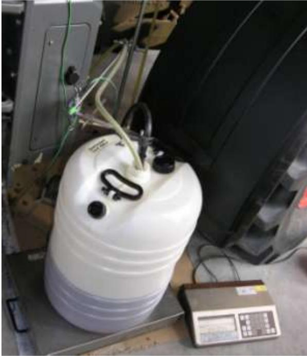
Abbildung 10: Aufbau zur Bestimmung des Kraftstoffverbrauchs mittels Wägung des Versuchskraftstoffbehälters
