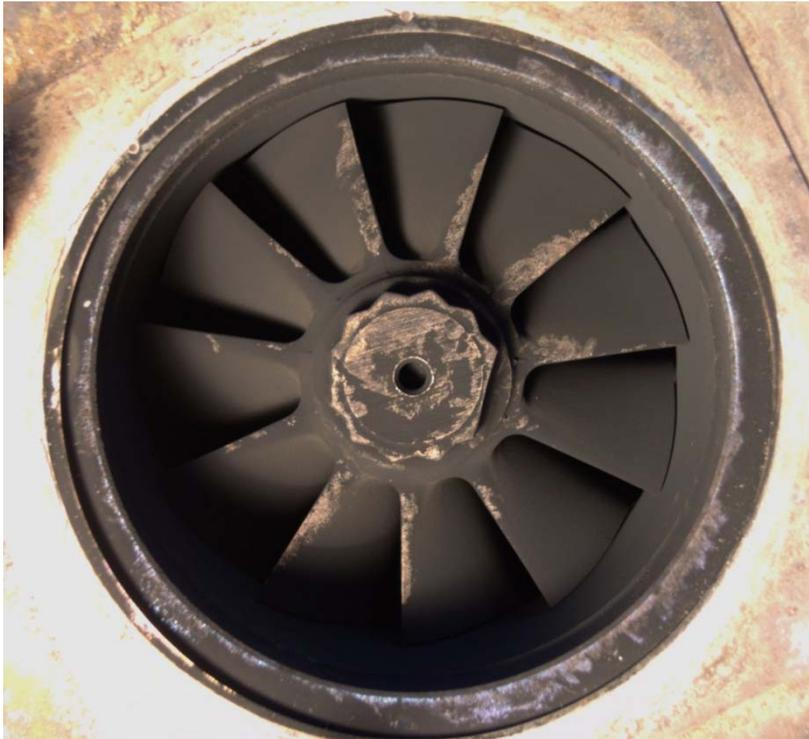
Abbildung 38: Turbinenrad des Abgasturboladers im Deutz-Fahr Agrotron TTV 1160
