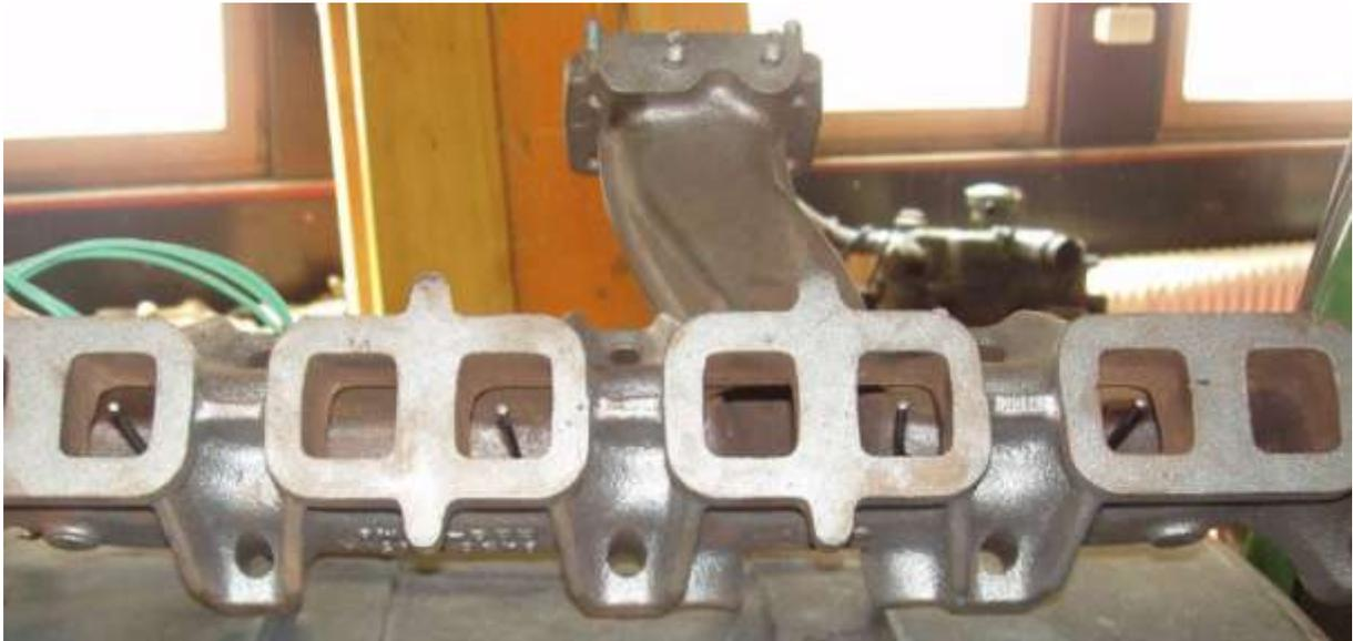
Abbildung 8: Abgaskrümmer des Fendt Farmer Vario 412 mit Temperatursensoren zur Erfassung der Abgastemperaturen an den einzelnen Zylindern
