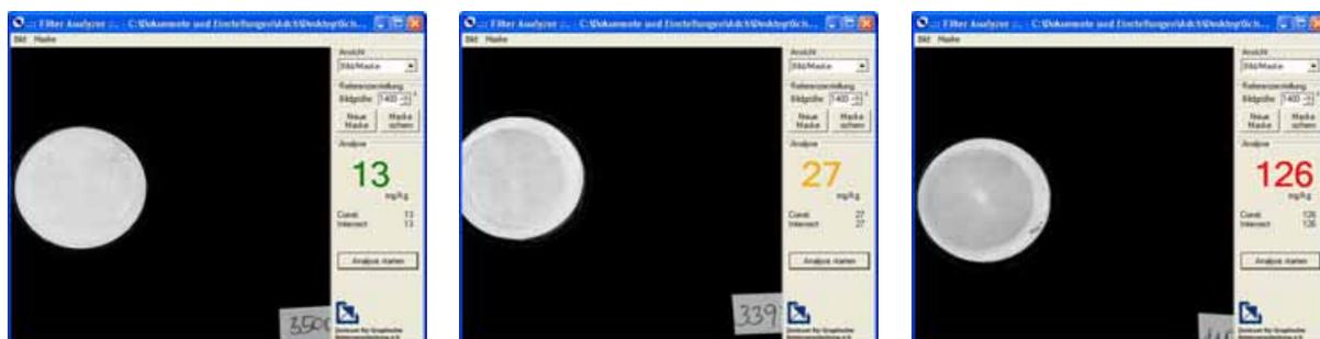
Abbildung 151: Analyse dreier Filter mit unterschiedlichem Verschmutzungsgrad – links: Probe liegt unter dem Grenzwert, mitte: Probe liegt im Grenzwertbereich und rechts: Probe liegt über dem Grenzwert
