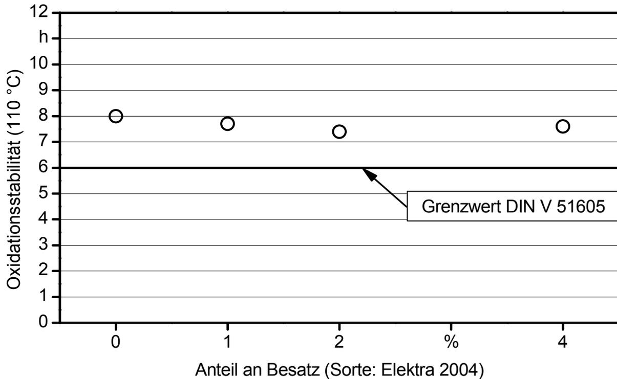
Abbildung 62: Oxidationsstabilität (DIN EN 14112) der Ölproben aus Rapssaat mit verschiedenen Anteilen an Besatz
