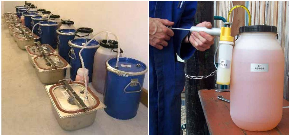
Abbildung 21: Aufbau der Lagervariante „dunkel 20 °C“ und Probenahme bei den Untersuchungen zur Lagerung von Rapsölkraftstoff
