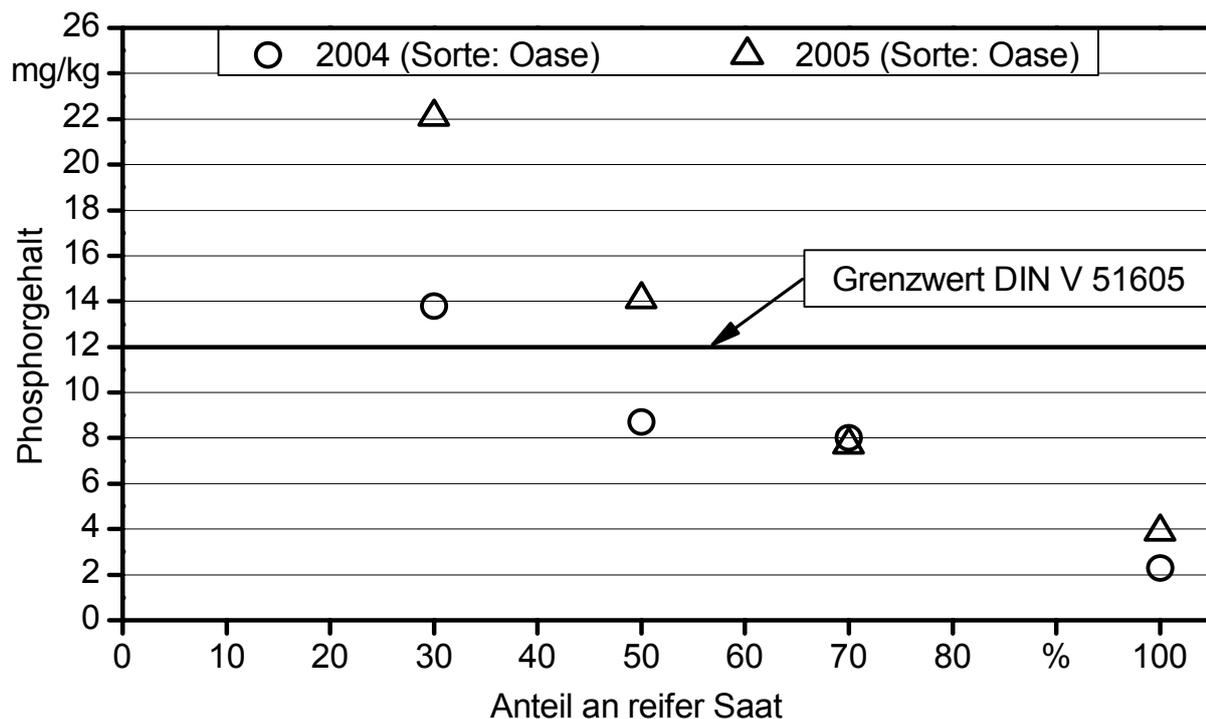
Abbildung 70: Phosphorgehalt (DIN EN 14107) der Ölproben aus Rapssaat mit verschiedenen Anteilen an reifer Saat
