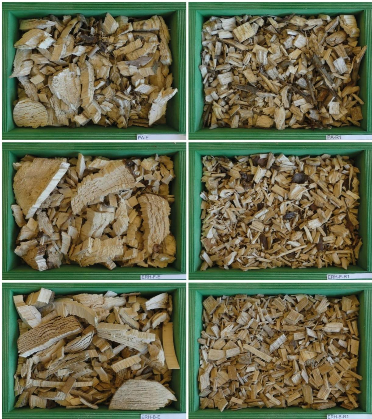
**Abbildung 5:** Bei den stationären Versuchen mit dem Effiter 20.30 und dem Referenzhacker erzeugten Brennstoffe in identischen Holzrahmen (320 × 245 mm Außenmaß); links: Effits; rechts: Referenzbrennstoffe; von oben nach unten: Pappel, Energierundholz aus Fichte, Energierundholz aus Buche
