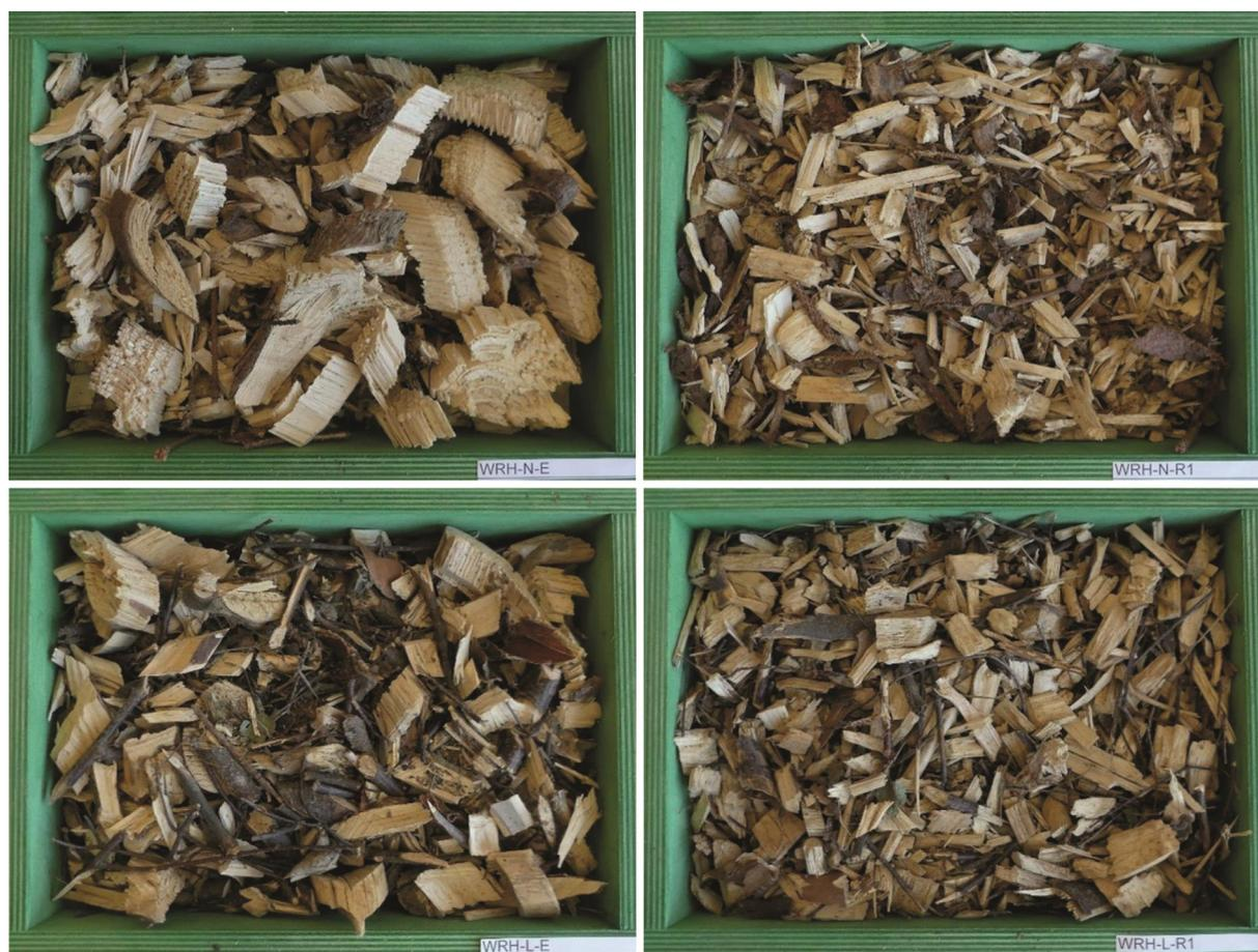
*Abbildung 6: Bei den stationären Versuchen mit dem Effiter 20.30 und dem Referenzhacker erzeugten Brennstoffe in identischen Holzrahmen (320 × 245 mm Außenmaß); links: Effits; rechts: Referenzbrennstoffe; von oben nach unten: Waldrestholz aus Nadelholz und Waldrestholz aus Laubholz*
