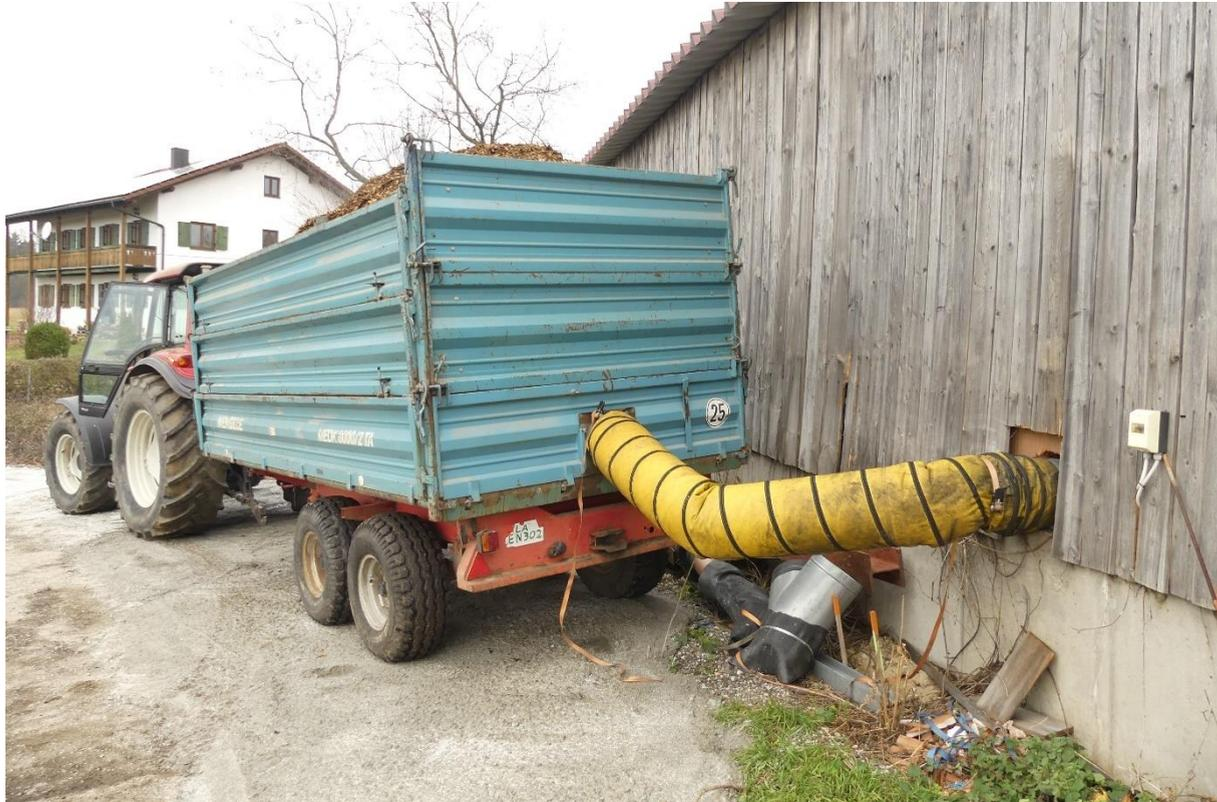
*Abbildung 69: Trocknung der Brennstoffe mit Abwärme des Holzgas-BHKW bei den Versuchen im industriellen Maßstab 2020*
