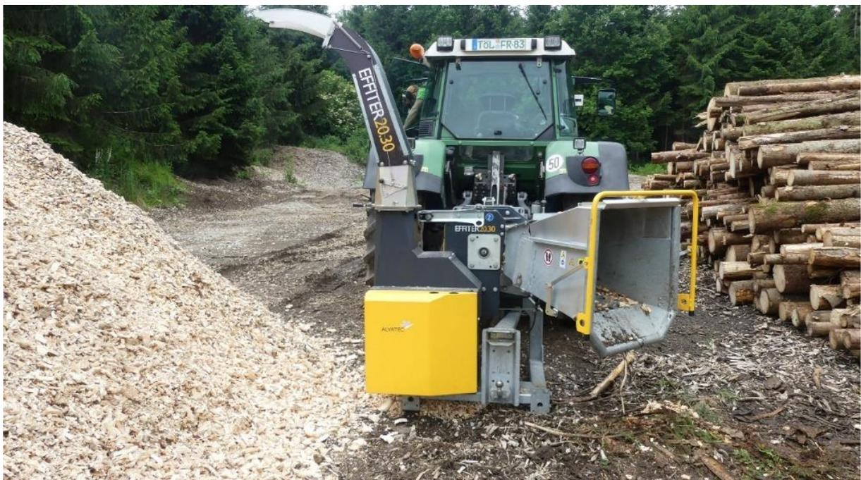
Abbildung 1: Effiter 20.30 mit trichterförmiger Brennstoffzuführung und Auswurfkamin („Puls-Craft-Austragung“)
