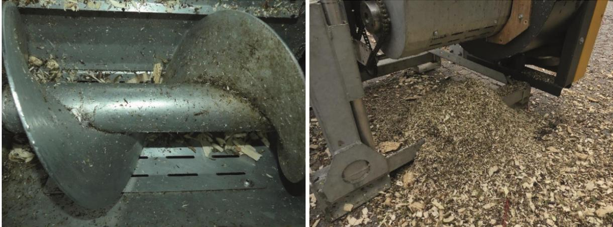
*Abbildung 23: Langlöcher im Quersförderer des Effiters 20.30 (links) und durch die Langlöcher abgeschiedener Feinanteil nach der Zerkleinerung von Pappelholz, der rückseitig aus dem Effiter 20.30 abgeschieden wird (rechts)*
