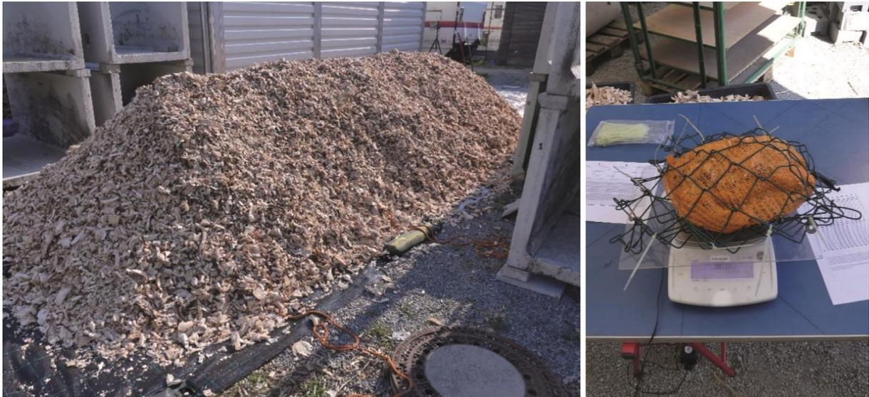
*Abbildung 13: Noch nicht abgedeckte Versuchsmiete aus Effits, mit Bilanzbeuteln und Temperaturloggern (nicht sichtbar) versehen (links). Wiegen eines befüllten Bilanzbeutels vor dem Einbringen in die Miete (rechts)*
