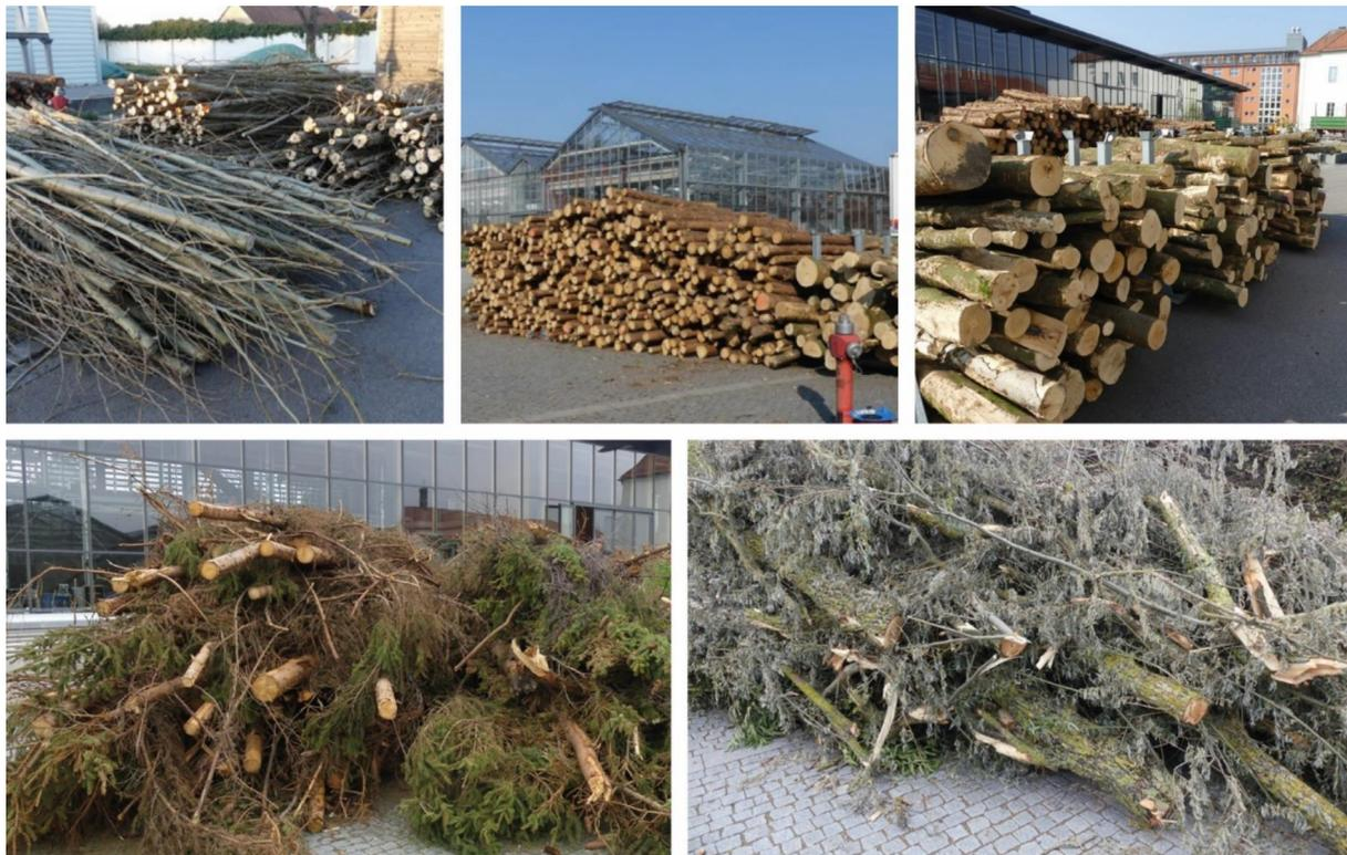
**Abbildung 3:** Rohmaterialien im ungehackten Zustand (oben links: Pappel aus einer Kurzumtriebsplantage; oben Mitte: Energierundholz aus Fichte; oben rechts: Energierundholz aus Buche; unten links: Waldrestholz aus Nadelholz; unten rechts: Waldrestholz aus Nadelholz)
