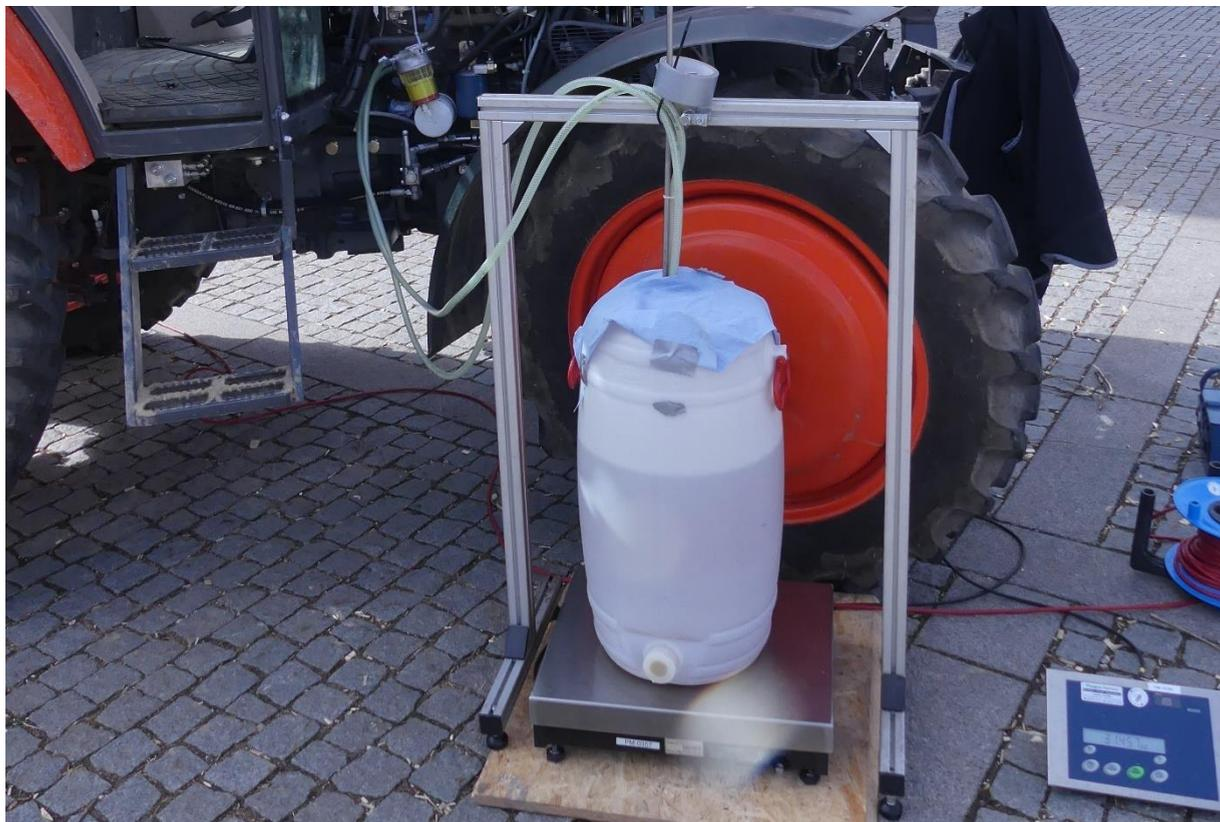
Abbildung 4: Messaufbau zur Bestimmung des Kraftstoffverbrauchs des Schleppers
