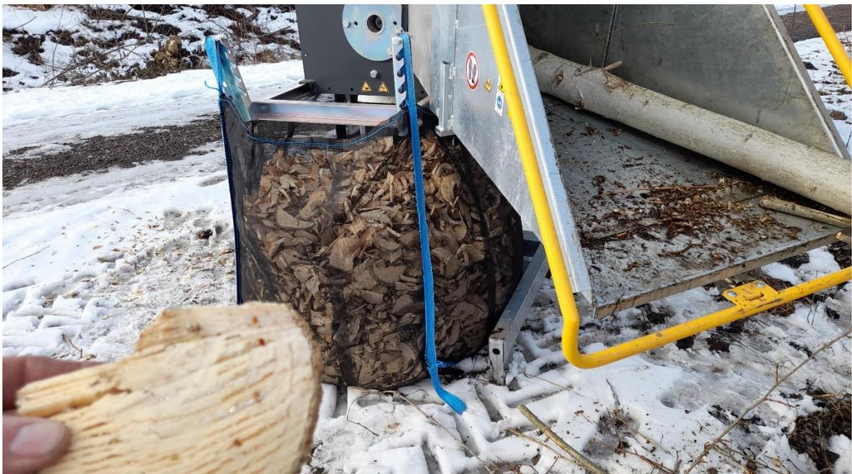
Abbildung 29: Vom Hersteller des Effiters 20.30 angebotene, luftdurchlässige Trocknungs-Big-Bags zur Lagerung und natürlichen Trocknung der Effits
