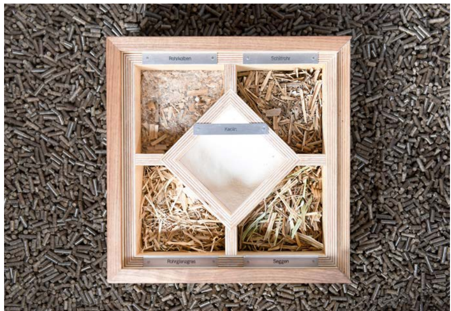
▣ Bild 1: Paludi-Brennstoffe (Häckselgut) von der Versuchsfläche „Freisinger Moos“: Rohrkolben ( Typha ssp. , oben links); Schilfrohr ( Phragmites australis , oben rechts); Rohrglanzgras ( Phalaris arundinacea , unten links); Seggen ( Carex ssp. , unten rechts); gemahlener Kaolin (Mitte). Im Hintergrund sind am TFZ produzierte Seggen-Pellets zu sehen (Foto: Tobias Hase, StMELF)
