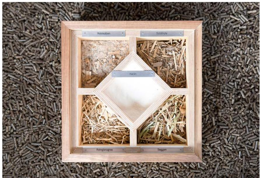
■ Bild 1: Paludi-Brennstoffe (Häckselgut) von der Versuchsfläche „Freisinger Moos“: Rohrkolben (*Typha ssp.*, oben links); Schilfrohr (*Phragmites australis*, oben rechts); Rohrglanzgras (*Phalaris arundinacea*, unten links); Seggen (*Carex ssp.*, unten rechts); gemahlenes Kaolin (Mitte). Im Hintergrund sind am TFZ produzierte Seggen-Pellets zu sehen (Foto: Tobias Hase, StMELF)
