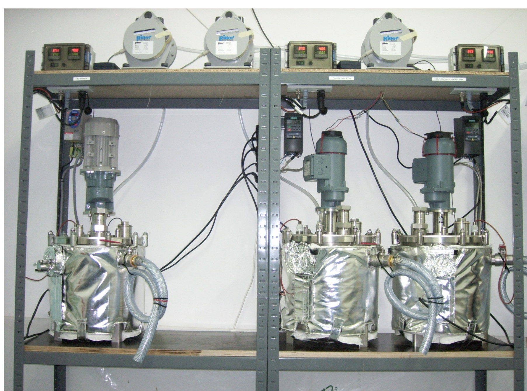
Simulation eines kontinuierlichen Betriebs mittels 20L-Kleinfermentationsanlage
