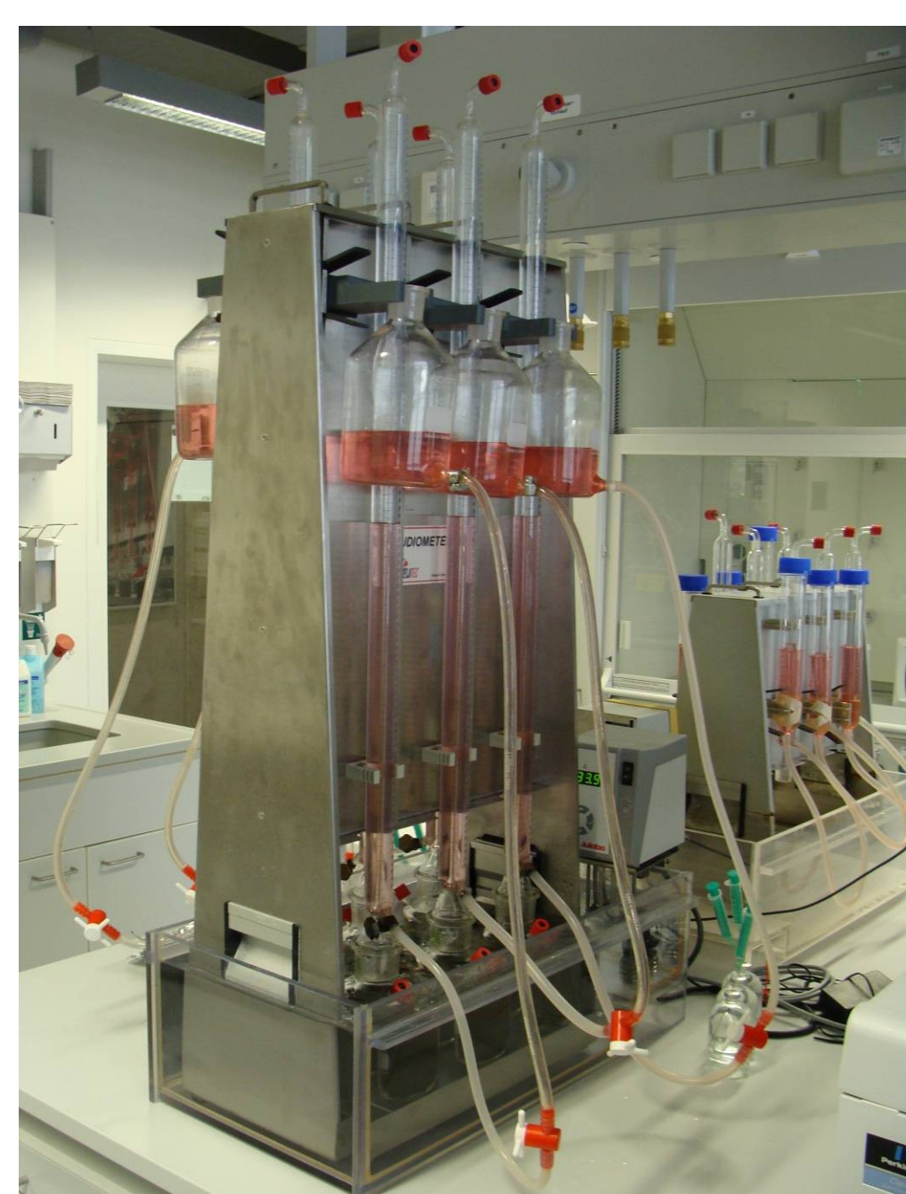
Bestimmung des Biogaspotenzials mittels Eudiometerteststand
