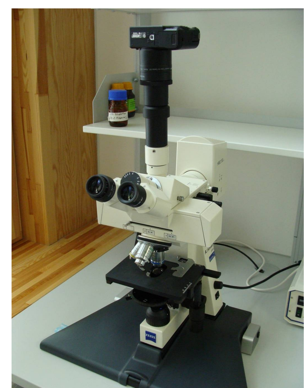
Keimzahlbestimmung/Methanogene mittels Fluoreszenzmikroskopie
