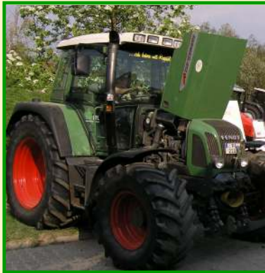
Fendt Farmer Vario 412 4 Zylinder 125 PS Baujahr 2003 Abgasstufe 1 Umrüstung: Fa. VWP (2003)
