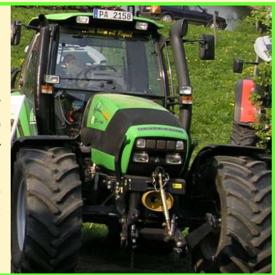
Deutz-Fahr Agrotion TTV 1160 6 Zylinder 162 PS Baujahr 2005 Abgasstufe 2 Umrüstung: Fa. Hausmann (2006)
