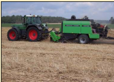
Pressen mit Großballenpresse und Häckslervorsatz
