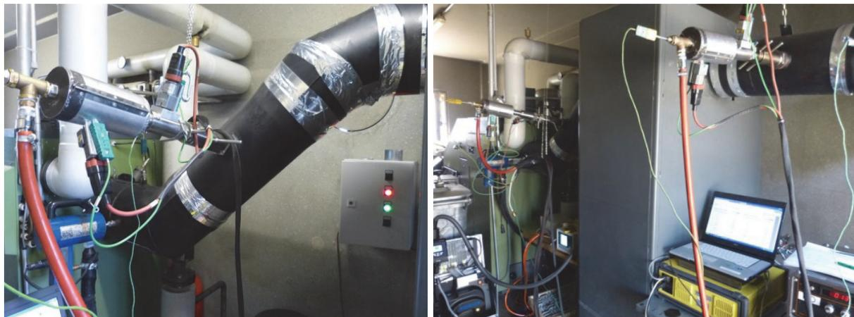
Abbildung 3: Abbildungen des Versuchsaufbaus während der Feldmessungen (links: Rohgasmessung; rechts: Roh- und Reingasmessung vor und nach dem Abscheider)
