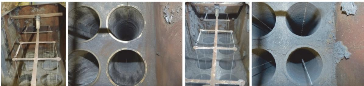
Abbildung 11: Vergleich zwischen unbeladenen Hochspannungs- und Abscheideelektroden (ganz links und links) und mit Staubfracht beladenen ungereinigten Hochspannungs- und Abscheideelektroden (rechts und ganz rechts)
