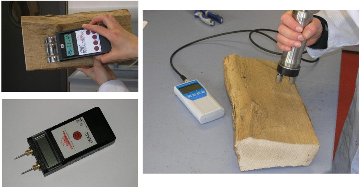
Abbildung 15: Messgeräte zur Schnellbestimmung des Wassergehaltes nach dem dielektrischen Messprinzip (oben) bzw. über elektrische Leitfähigkeitsmessung mit Einstechnadeln (unten) oder Einschlagelektroden (rechts)
