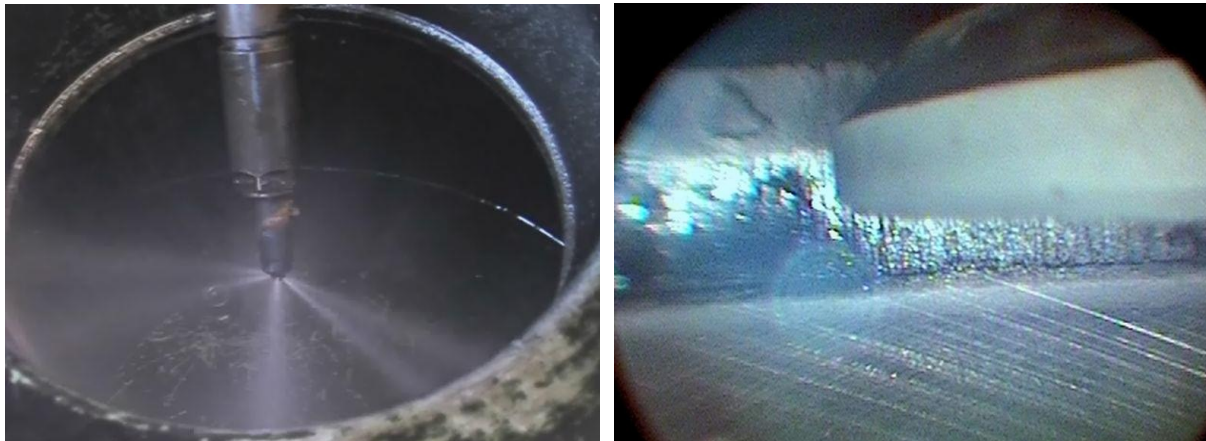
Abbildung 21: Spritzbild der Einspritzdüse von Zylinder 5 des Deutz-Fahr TTV 1160 nach 903 Bh (links) und Zylinderwand mit Honriefen und Feuersteg sowie Ventilteller nach 1500 Bh (rechts)
