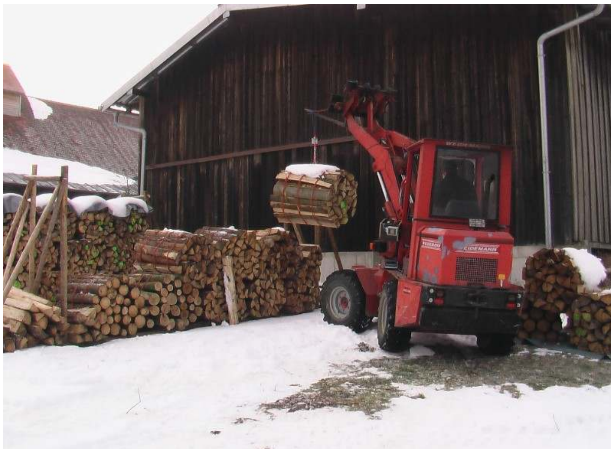
Abbildung 17: Monatliche Gewichtsmessung der Rundbündel mit einer Wiegezelle. Im Hintergrund: Lagervariante mit Abdeckung
