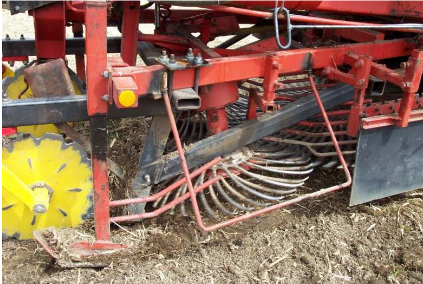
Abbildung 12: Scheibensech und Rodeaggregat des Ladebunkers
