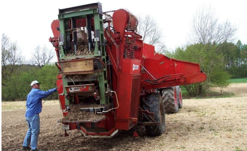
Abbildung 13: Ladebunker mit Stanzaggregat
