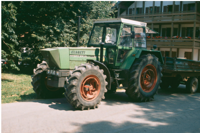
Pflanzenöлтаuglicher Traktor im Feldversuch, umgerüstet nach dem Elsbett-Prinzip (um 1990)
