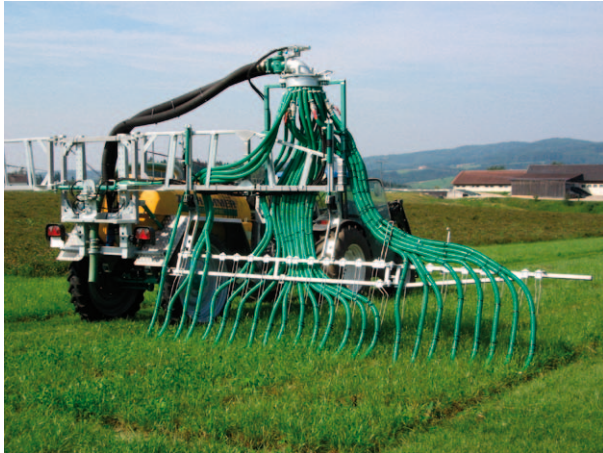
Abbildung 6: Gärrestausbringung im Versuchsmaßstab mit dem Parzellengüllefass des TFZ
