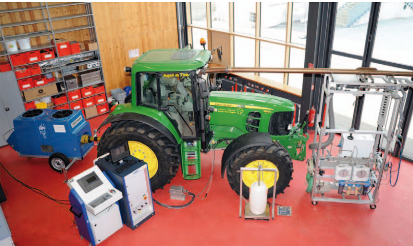
Prüfstandsmessung an einem modernen pflanzenötauglichen Traktor (2011)
