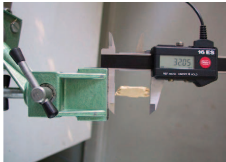
Bild 1: Handvermessene Teilchen einer Referenzprobe für die Kalibrierung von Siebanlagen zur Bestimmung der Korngrößenverteilung
