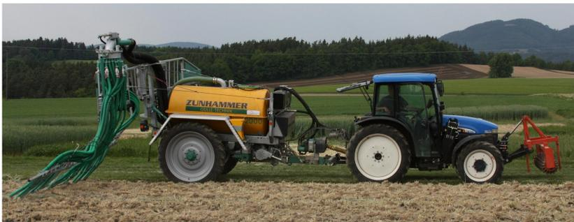
Abbildung 1: Bodennahe Gärrestausrückführung mit Schleppschläuchen
