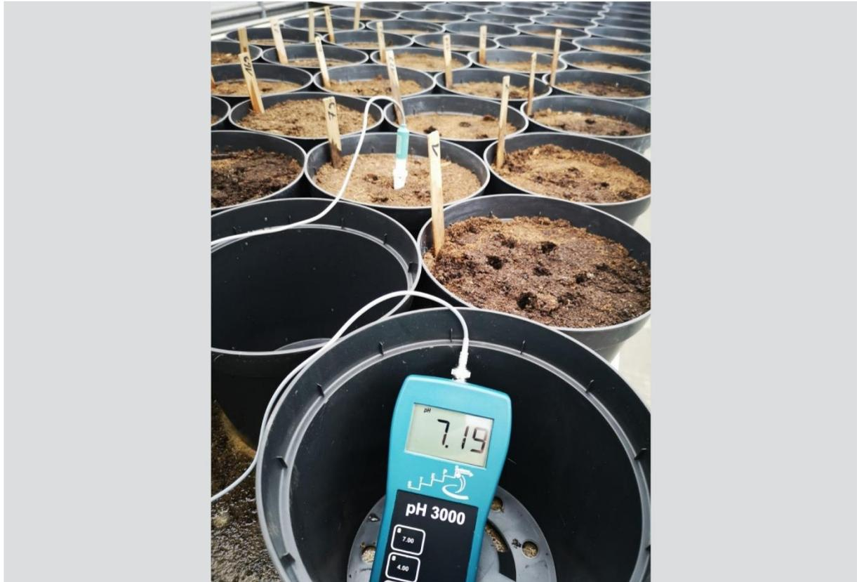
Abbildung 29: pH-Messung mit Boden-pH-Meter direkt im feuchten Substrat
