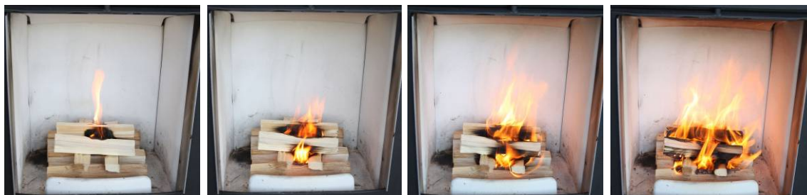
Bild 2: Anheizphase eines Kaminofens
