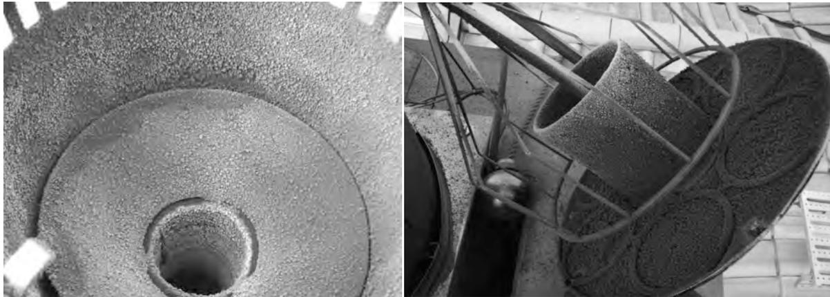
Abbildung 36: Kopf (links) und Deckel (rechts) des APP  $R_{\text{esidential}}$  ESP mit Ascheablagerungen
