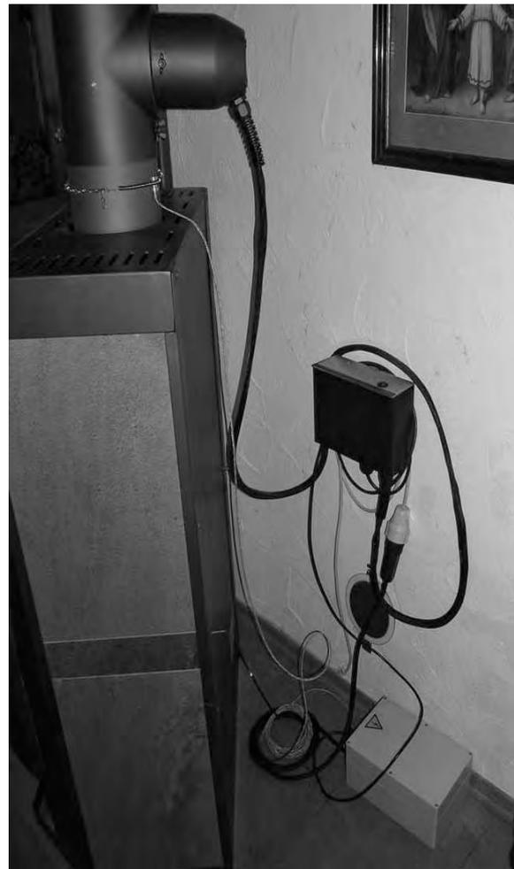
Abbildung 8: KW Zumikron im Rauchrohr, Schaltkasten an der Wand und Datalogger des TFZ am Boden
