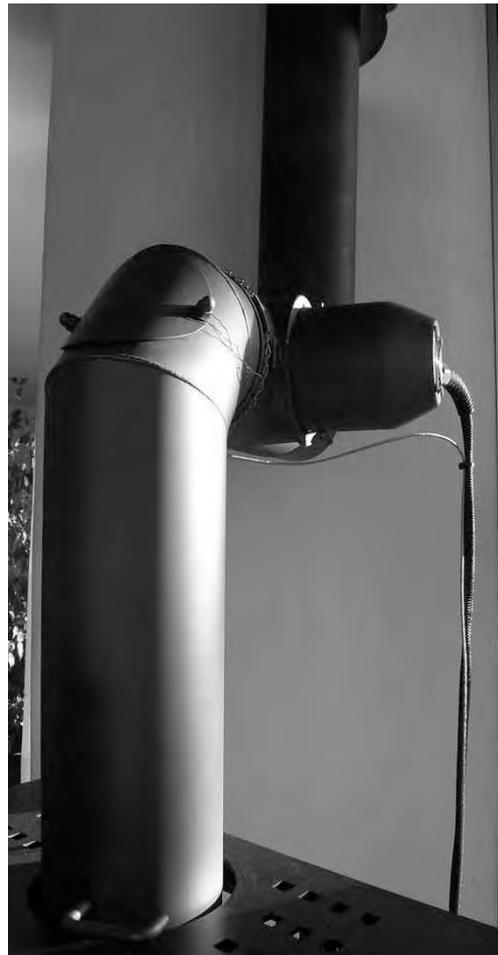
Abbildung 6: KW Zumikron im Rauchrohr
