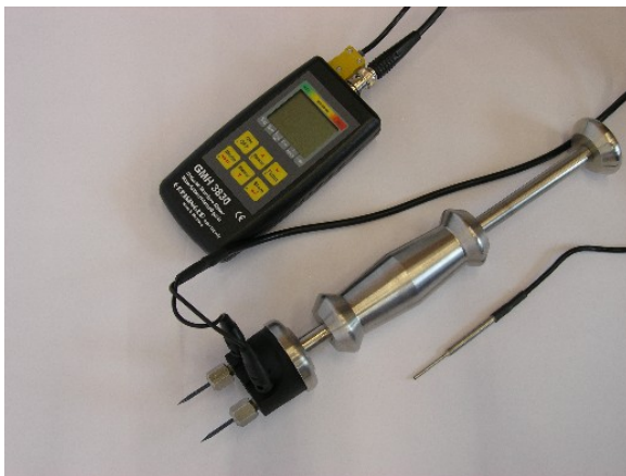
Abbildung 25: Leitfähigkeitsmessgerät Fabrikat Greisinger, Typ GMH 3830 mit Einschlagelektrode GHE 91
