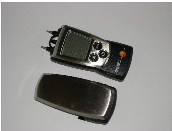
Abbildung 42: Leitfähigkeitsmessgerät Fabrikat testo, Typ 606-1 mit Einstechnadeln
