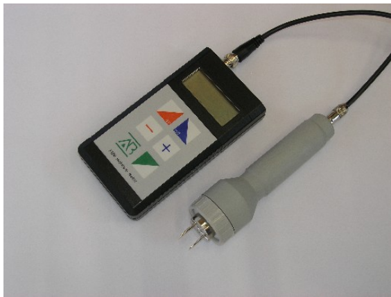
Abbildung 36: Leitfähigkeitsmessgerät Fabrikat PCE, Typ FME mit Fühler NF 4-17
