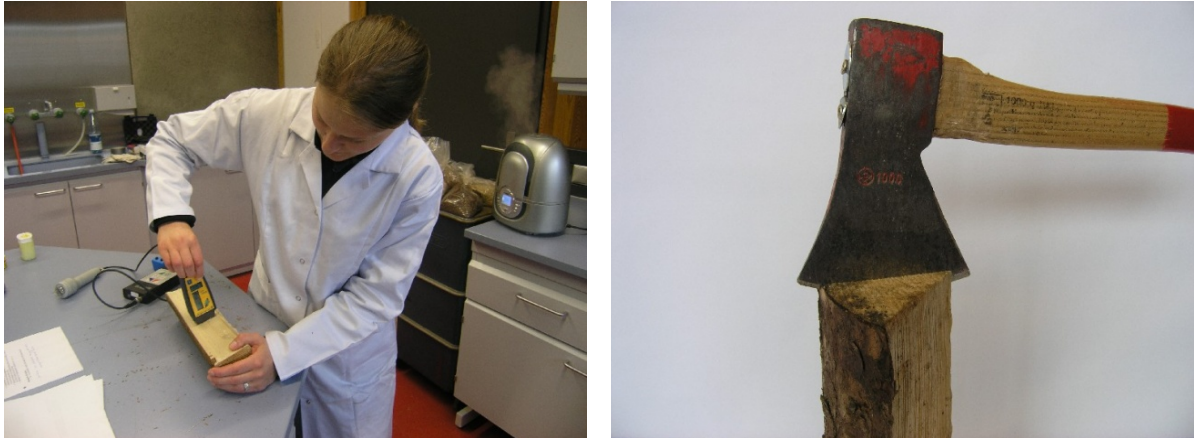
Abbildung 9: Feuchteschnellbestimmung am Beispiel eines Fichten-Holzschaites mit dem Messgerät BES Bollmann, Easy-comfort, Nadelmodus, (links) und Spalten des Holzschaites mit der Axt, (rechts)
