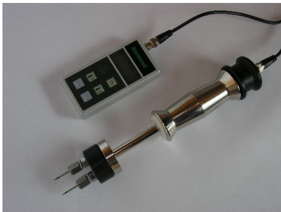
Abbildung 32: Leitfähigkeitsmessgerät Fabrikat Lignomat, Typ maxiLigno mit Einschlagelektrode E 12
