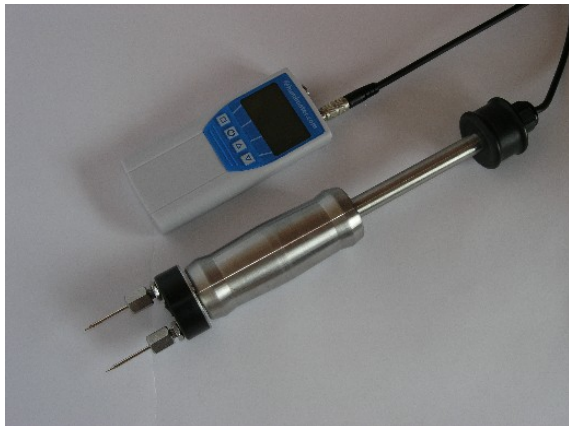
Abbildung 40: Leitfähigkeitsmessgerät Fabrikat Schaller, Typ humimeter BLW mit Rammeelektrode
