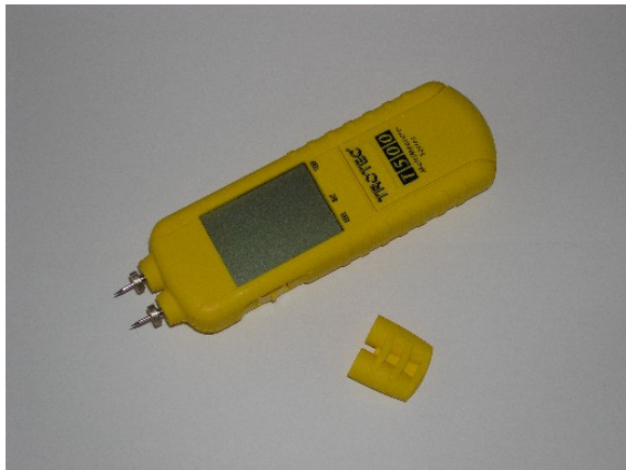
Abbildung 44: Leitfähigkeitsmessgerät Fabrikat TROTEC, Typ T 500 mit Einstechnadeln
