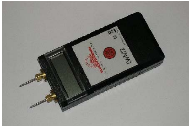
Abbildung 17: Leitfähigkeitsmessgerät Fabrikat Dosser, Typ LWM 2 mit Einstechnadeln
