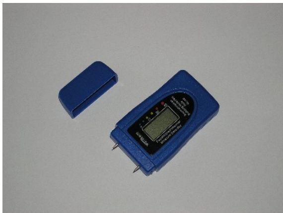
Abbildung 48: Leitfähigkeitsmessgerät Fabrikat Wetekom, Typ MD-018 mit Einstechnadeln
