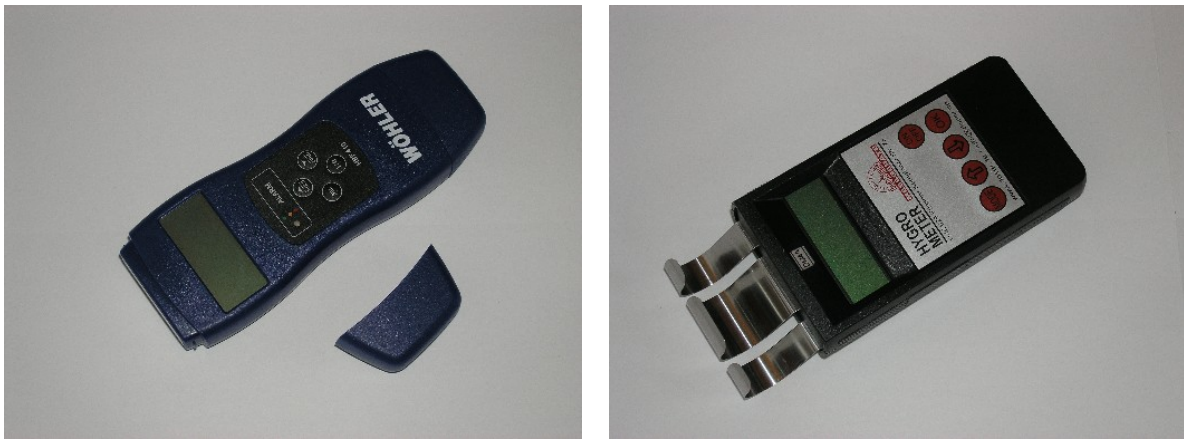
Abbildung 4: Kapazitives Messgerät Fabrikat Wöhler, Typ HBF 410, mit Kondensatorplattenoberfläche (links) und kapazitives Messgerät Fabrikat Doser, Typ DM 4 A, mit Oberflächen-Federelektroden (rechts)
