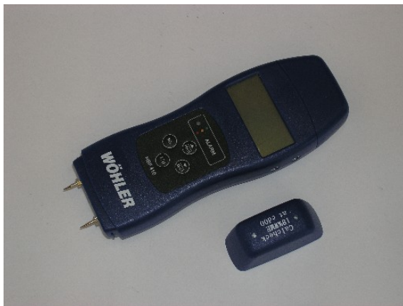
Abbildung 50: Feuchtemessgerät Fabrikat Wöhler, Typ HBF 410, mit Einstecknadeln
