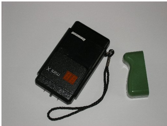
Abbildung 34: Leitfähigkeitsmessgerät Fabrikat Lignomat, Typ mini X mit Einstechnadeln
