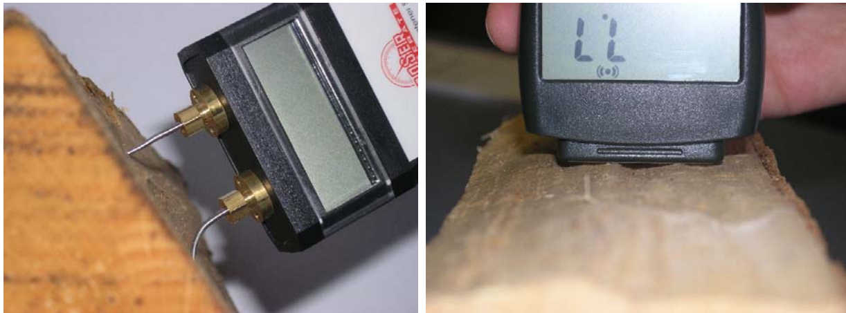
Abbildung 10: Verbogene Messstifte (Nadeln) am Beispiel Fabrikat Doser, LWM 2, (links) sowie unebene Auflagefläche an einem Holzscheit (hier Fabrikat HEDÜ, 2 in 1, Kontaktmodus), (rechts)
