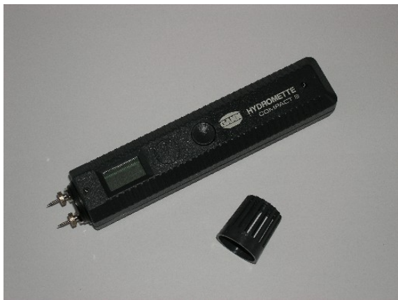
Abbildung 21 Leitfähigkeitsmessgerät Fabrikat Gann, Typ Hydromette Compact S mit Einstechnadeln
