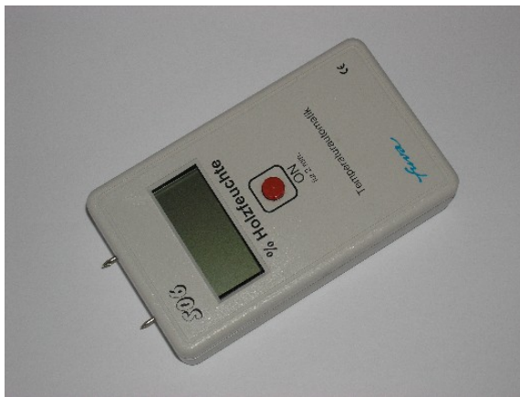
Abbildung 19: Leitfähigkeitsmessgerät Fabrikat Fuva, Typ S 06 mit Einstechnadeln
