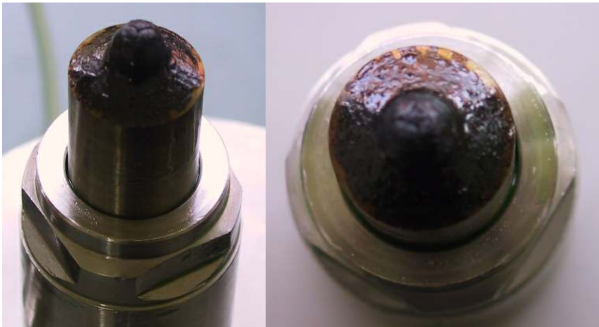
Abbildung 25: Ablagerungen an der Einspritzdüse des FIT-1 nach mehreren Cetanzahlmessungen von Rapsölkraftstoff
